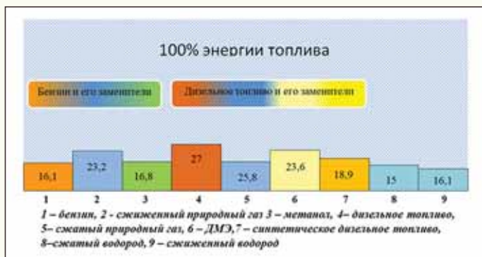
Рис. 3. Суммарный КПД энергоносителей на различных энергетических установках
