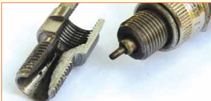
Препарированное форкамерное устройство Ф-1 отдельно от свечи зажигания
