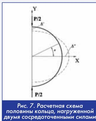
Рис. 7. Расчетная схема половины кольца, нагруженной двумя сосредоточенными силами
