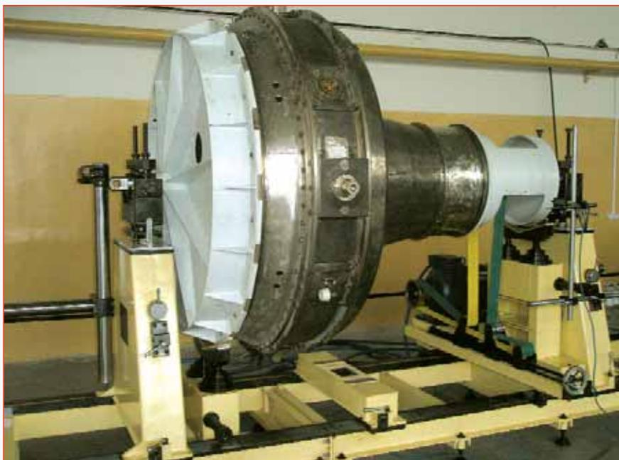
Рис. 6. Балансировочный станок VM-3000 со специальной оснасткой
