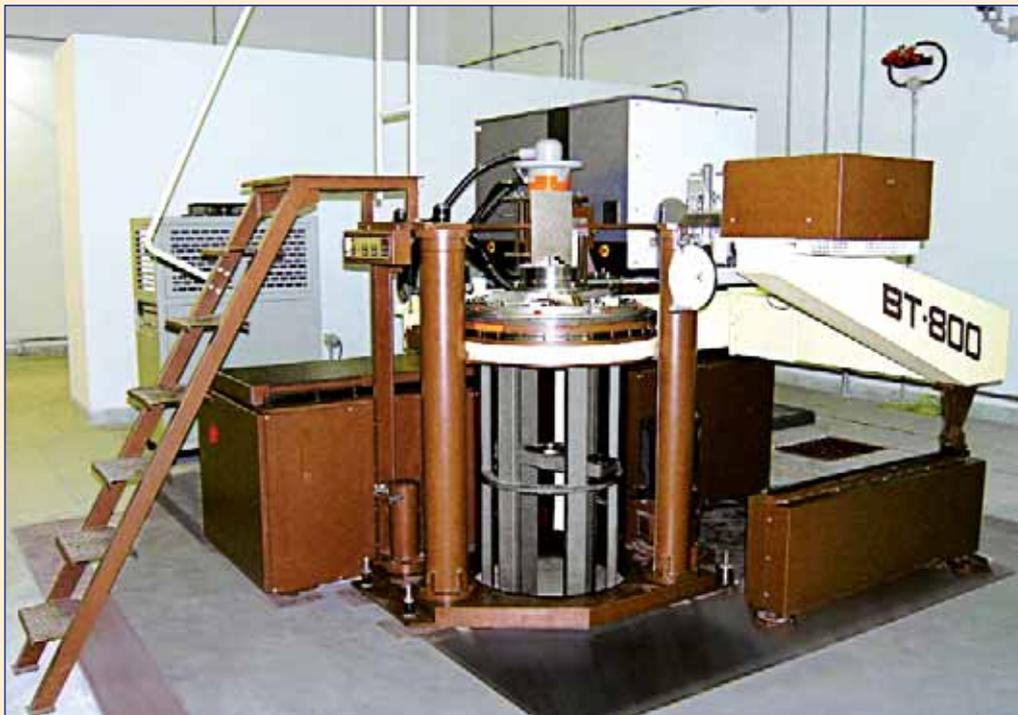
Рис. 2. Внешний вид высокоэнергетического томографа BT-800XA
