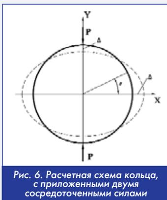
Рис. 6. Расчетная схема кольца, с приложенными двумя сосредоточенными силами
