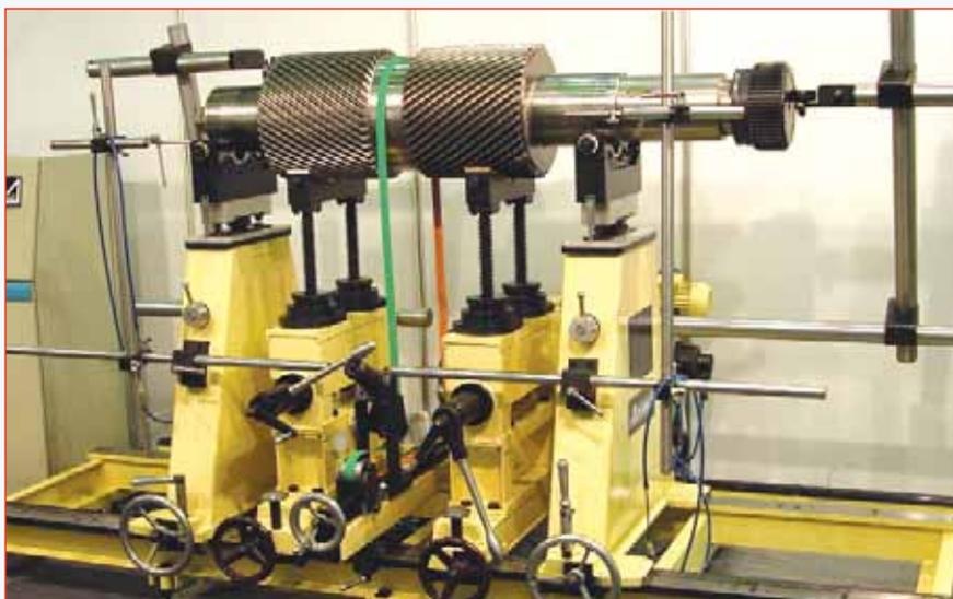
Рис. 3. Балансировочный станок VM-3000
