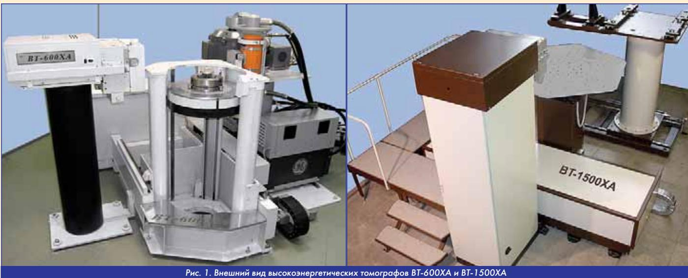
Рис. 1. Внешний вид высокоэнергетических томографов ВТ-600ХА и ВТ-1500ХА
