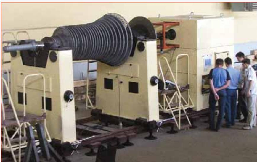
Рис. 1. Балансировочный станок ВМ-36000 грузоподъёмность 40 т
