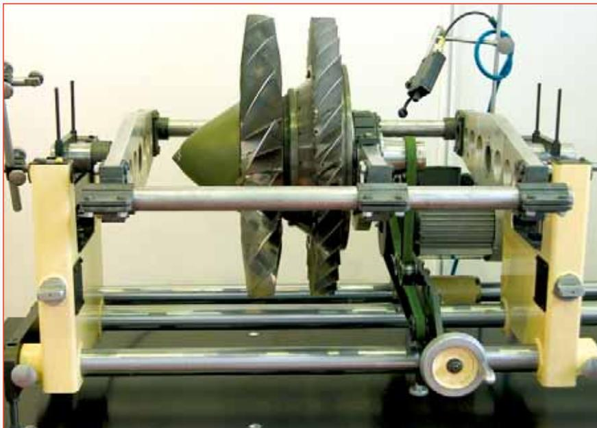
Рис. 5. Балансировочный станок VM-050 со специальной оснасткой
