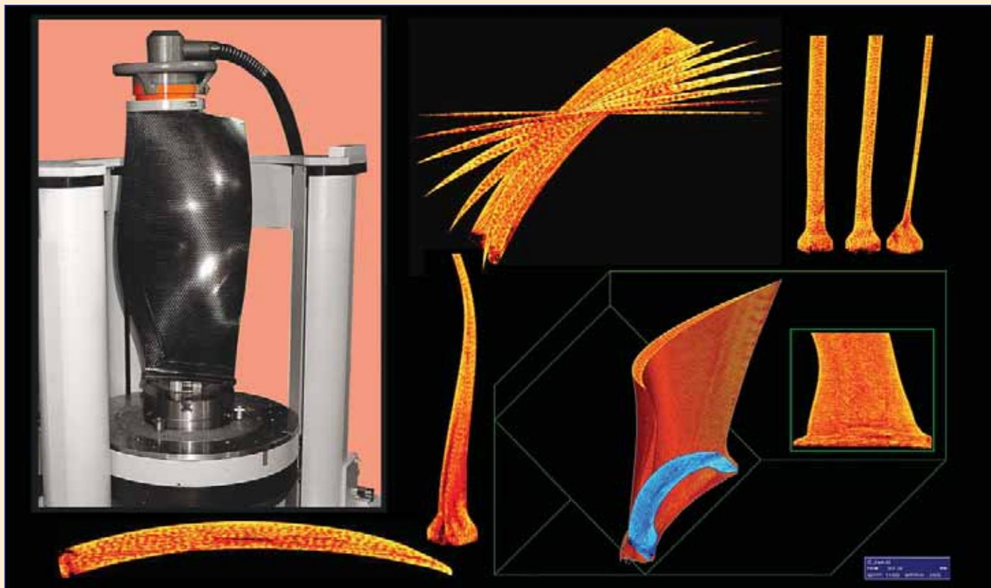
Рис. 11. Внешний вид и томограммы широкохордной углепластиковой лопасти вентилятора (710 x 400 x 40 мм)
