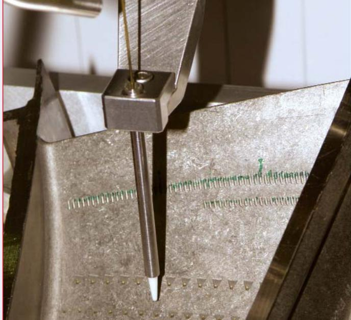
Станки фирмы Saig способны прошивать отверстия под любым углом
