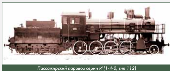
Пассажирский паровоз серии И (1-4-0, тип 112)
