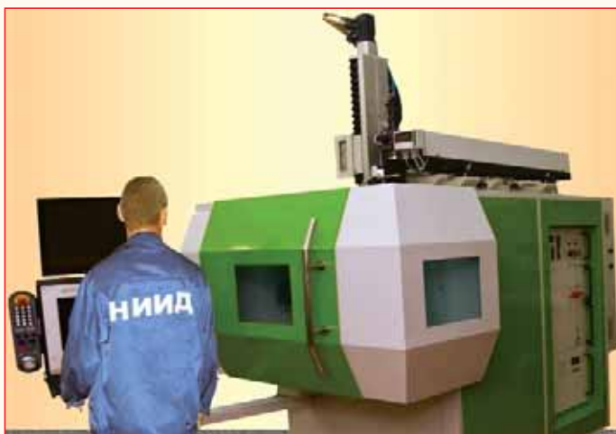
Пятикоординатный лазерный комплекс с интегрированной видеосистемой для обработки объемных деталей по 3-D моделям
