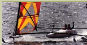
В продажу поступили парусники, конструкция которых аналогична яхте «Трифойлер» американца Г. Кеттермана. В 1992 г. эта яхта достигла скорости 80,6 км/ч. Её длина - 6,3 м, общая ширина - 5,5 м, масса 95 кг, площадь двух парусов от виндсёрфера - 13,9 м². Производством яхты с 1993 г. занимается немецкая фирма «Трифойлер»
