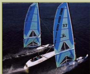
В продажу поступили парусники, конструкция которых аналогична яхте «Трифойлер» американца Г. Кеттермана. В 1992 г. эта яхта достигла скорости 80,6 км/ч. Её длина - 6,3 м, общая ширина - 5,5 м, масса 95 кг, площадь двух парусов от виндсёрфера - 13,9 м². Производством яхты с 1993 г. занимается немецкая фирма «Трифойлер»
