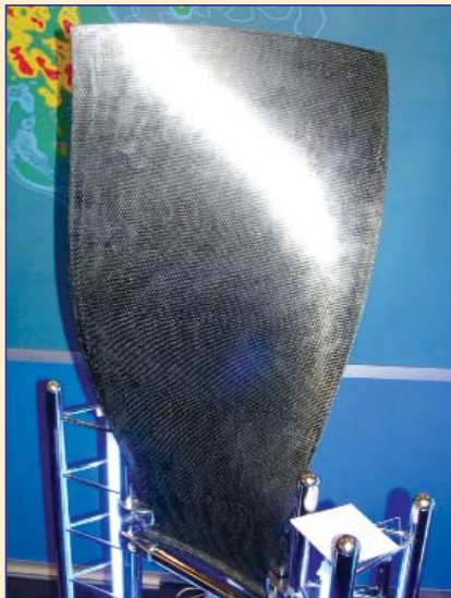
Лопатка РК модернизированного КНД из полимерного композита
