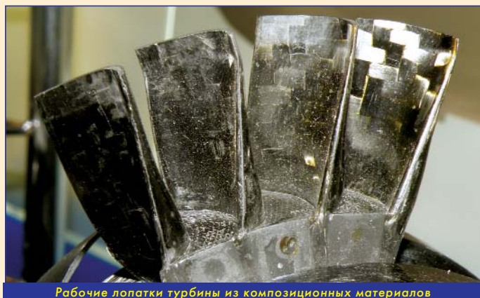
Рабочие лопатки турбины из композиционных материалов
