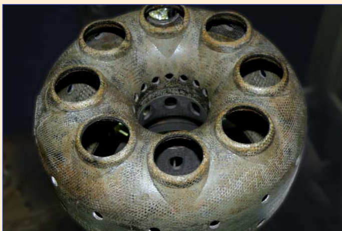
Жаровая труба из керамического композиционного материала
