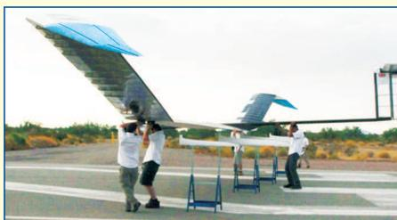
Предполагается, что БПЛА "Zephyr" будут изготавливаться в двух версиях: однофюзеляжном - "Zephyr-S" и двухфюзеляжном - "Zephyr-T", который отличается увеличенным размахом крыла, позволяющем нести до 20 кг полезной нагрузки.
