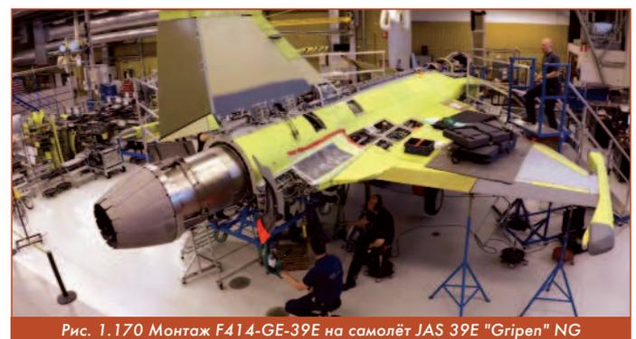
Рис. 1.170 Монтаж F414-GE-39E на самолёт JAS 39E "Gripen" NG
