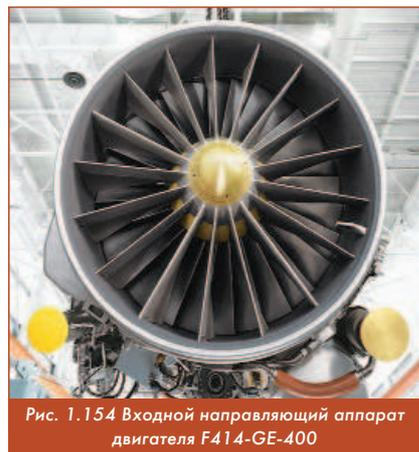
Рис. 1.154 Входной направляющий аппарат двигателя F414-GE-400
