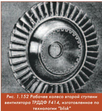
Рис. 1.152 Рабочее колесо второй ступени вентилятора ТРДДФ F414, изготовленное по технологии "blisk"
