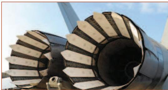
Рис. 1.177 Конструкция сопла с шумоподавлением
