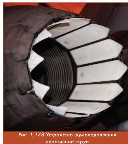
Рис. 1.178 Устройство шумоподавления реактивной струи
