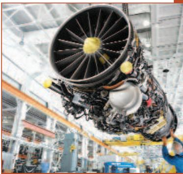
Рис. 1.166 Двигатель F414-GE-400 в сборочном цехе
