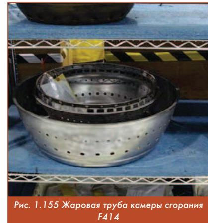
Рис. 1.155 Жаровая труба камеры сгорания F414
