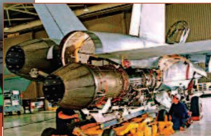
Рис. 1.165 Монтаж двигателя F414-GE-400 на самолёт
