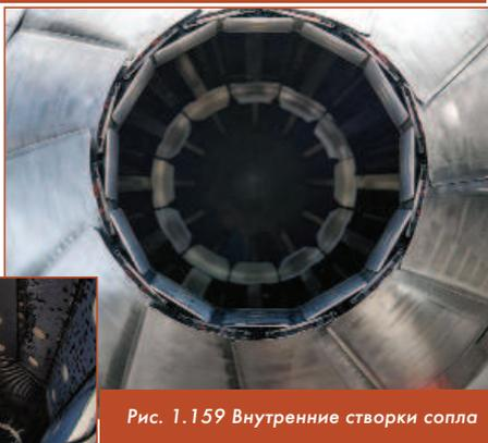
Рис. 1.159 Внутренние створки сопла
