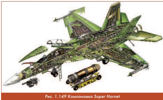
Рис. 1.149 Компоновка Super Hornet
