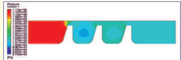
Рис. 11 Поле давления в исходной конструкции уплотнения
