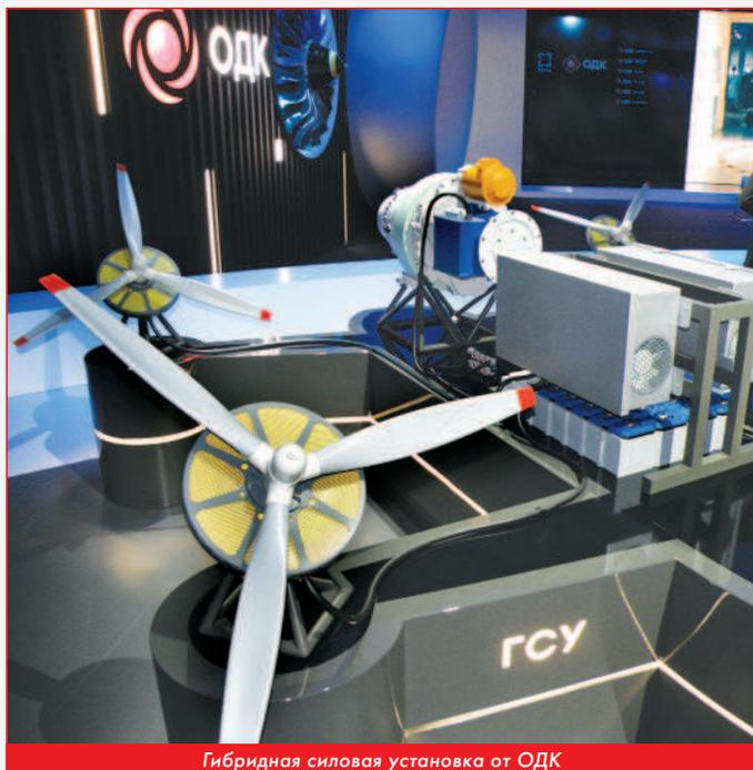
Гибридная силовая установка от ОДК
