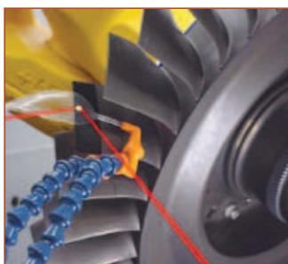
Рис. 1.181 Лазерная обработка лопаток. Красный лазерный луч используется для визуализации
