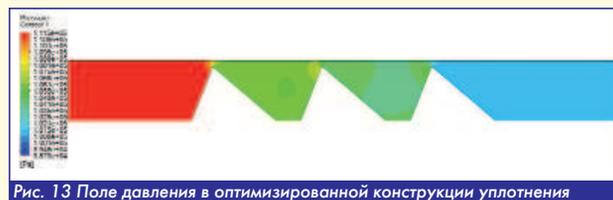
Рис. 13 Поле давления в оптимизированной конструкции уплотнения
