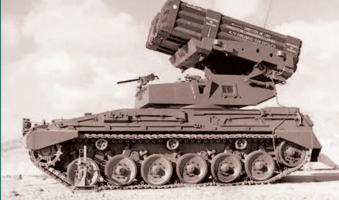
В каждой раме было по 18 трубчатых направляющих, изготовленных из стеклопластика, которые после боевого применения повторно не использовались. Снаряжение пакетов реактивными снарядами должно было осуществляться на заводе-изготовителе, после чего пакеты герметизировались и в таком положении могли храниться в течение 15 лет. После пуска всех снарядов с помощью специального крана выполняется замена пакетов, на что требуется до 10 минут.
