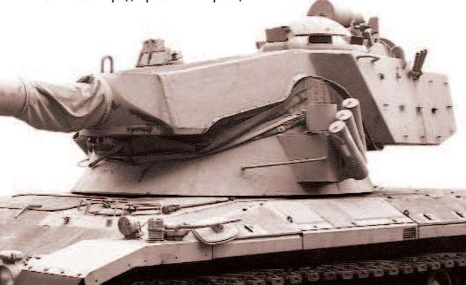
На первых серийных машинах были установлены импортированные из Франции качающейся башни FL-120S, а затем был налажен их лицензионный выпуск под индексом JT 1 на одном из заводов концерна Voest Alpine, причём, воспользовавшись наличием лицензии в конструкции башни, в неё были внесены необходимые изменения.
