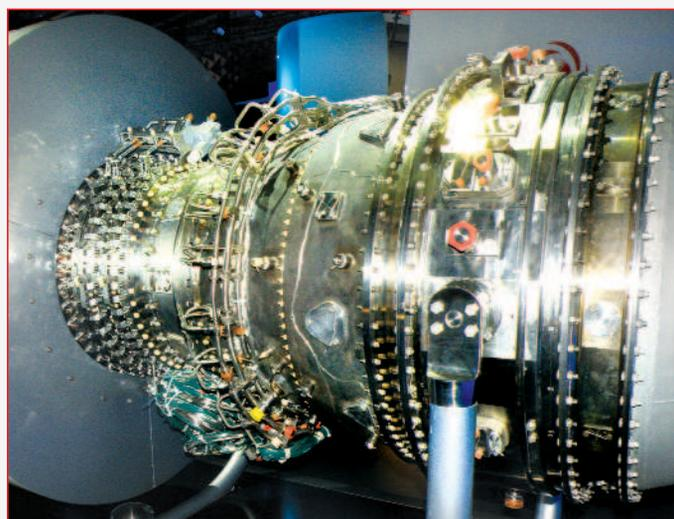
**Демонстратор газогенератора ПД-8**
