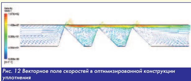
Рис. 12 Векторное поле скоростей в оптимизированной конструкции уплотнения
