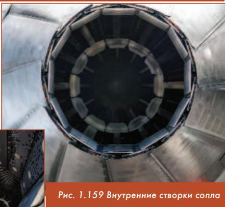
Рис. 1.159 Внутренние створки сопла
