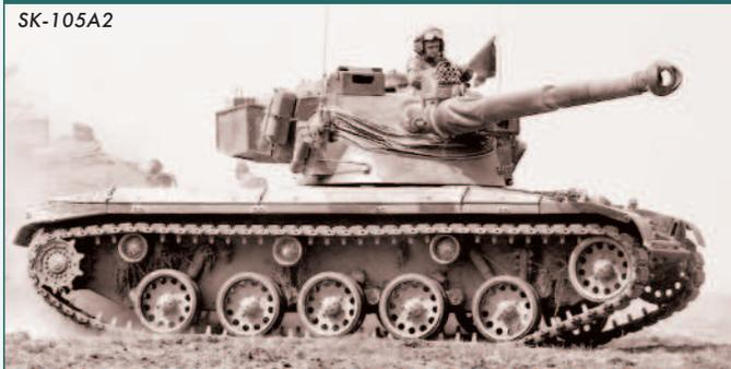
Если проанализировать снимки танков SK-105, то можно заметить, что на танках был разный состав оборудования, например, пушка от варианта A2, а на танке система управления огнём ещё с ИК-прожектором, т.е. не установлена не только тепловизионная камера, но и пассивные ночные прицелы у командира и наводчика, как это было сделано на варианте A1. Связано это было, видимо, с возможными ограничениями в финансировании.
