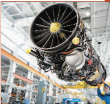
Рис. 1.166 Двигатель F414-GE-400 в сборочном цехе
