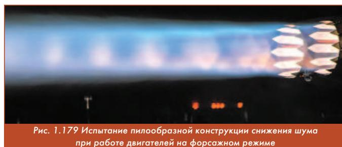
Рис. 1.179 Испытание пилообразной конструкции снижения шума при работе двигателей на форсажном режиме
