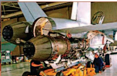
Рис. 1.165 Монтаж двигателя F414-GE-400 на самолёт
