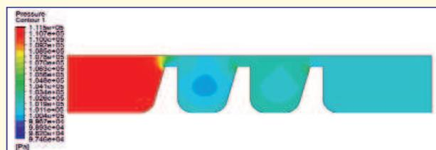
Рис. 11 Поле давления в исходной конструкции уплотнения
