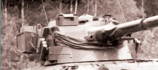
Экспериментальный SK-105. Вместо инфракрасных прожектора и прицела установлена телекамера
