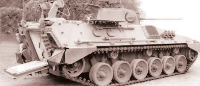
Вместо башни со 105-мм пушкой была установлена небольшая башня с 20-мм скорострельной пушкой Rh-202 и 7,62-мм зенитным пулемётом. Дополнительное вооружение БМП состоит из дистанционно управляемого 7,62-мм пулемета, установленного на крыше десантного отделения.
