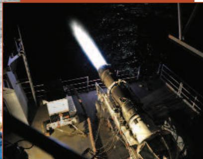
Рис. 1.167 Испытания ТРДДФ F414-GE-400 на борту авианосца
