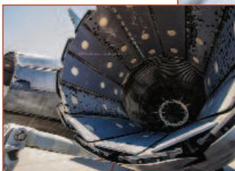
Рис. 1.160 Внешние створки сопла
