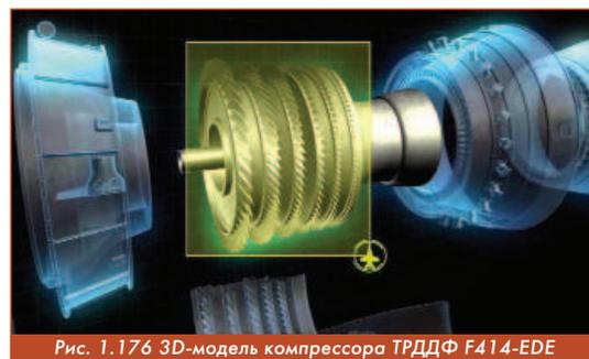
Рис. 1.176 3D-модель компрессора ТРДДФ F414-EDE
