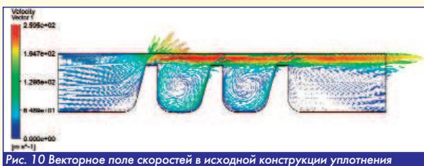
Рис. 10 Векторное поле скоростей в исходной конструкции уплотнения
