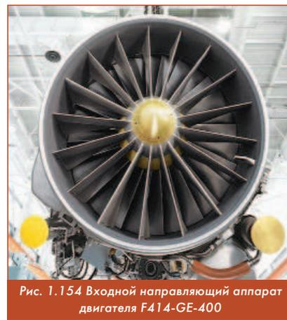
Рис. 1.154 Входной направляющий аппарат двигателя F414-GE-400
