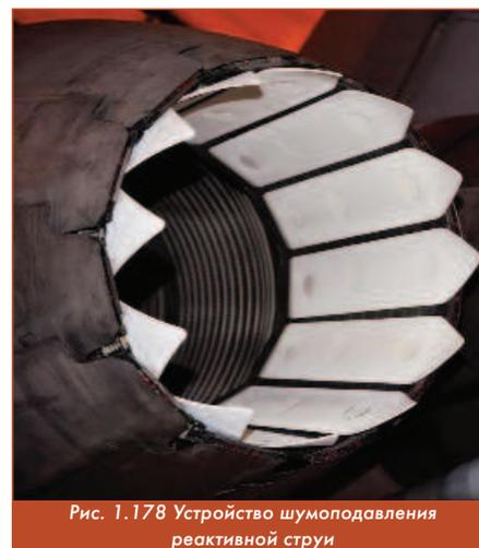
Рис. 1.178 Устройство шумоподавления реактивной струи
