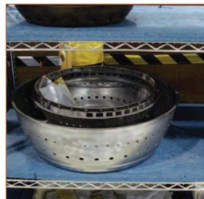
Рис. 1.155 Жаровая труба камеры сгорания F414
