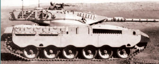
В башне находятся места для трех членов экипажа: заряжающего, командира танка и наводчика. Место заряжающего расположено слева от орудия, при необходимости он может выполнять функции наводчика или водителя. Место наводчика - справа от орудия, для выполнения своих функций он располагает оптическим прицелом с лазерным дальномером и баллистическим вычислителем. Для общего обзора есть перископический прибор.
