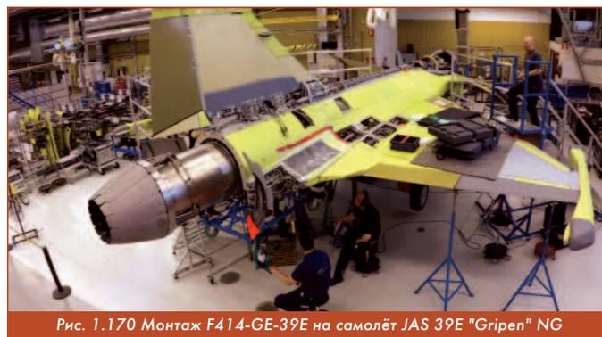
Рис. 1.170 Монтаж F414-GE-39E на самолёт JAS 39E "Gripen" NG
