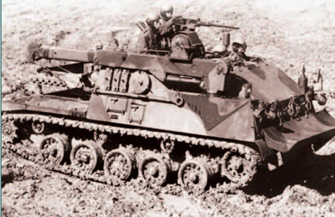
И уже на базе "ARV Greif" для австрийской армии был разработан инженерный танк "4KH7FA-Pi", у которого используется бульдозерный отвал другой конструкции, установлена лебедка с тягой всего 8 тс, а вместо крана установлен гидравлический экскаватор. Возможна работа экскаватора с ковшом как с прямым, так и обратным направлением лопаты. Машина имеет массу 19 тонн, в экипаже четыре человека, а на вооружении тот же самый пулемет M2HB.
