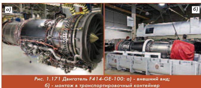
Рис. 1.171 Двигатель F414-GE-100: а) - внешний вид; б) - монтаж в транспортировочный контейнер
