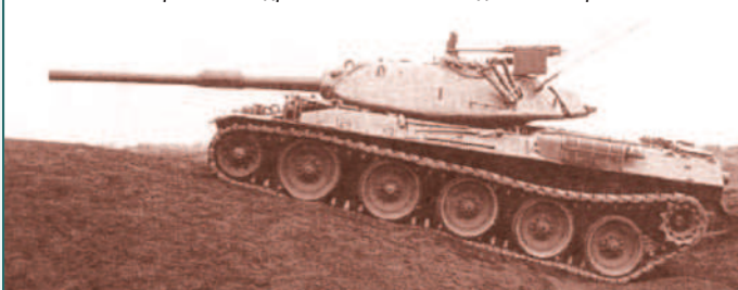
Устранение крена на склоне благодаря гидропневматической подвеске
