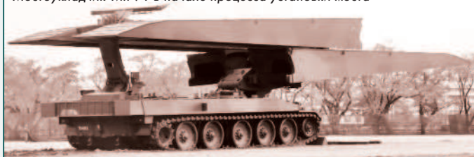
Мостоукладчик Тип 91 на заключительном этапе установки моста
