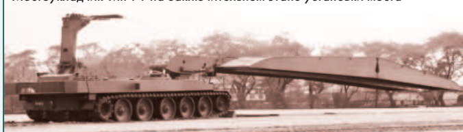
Мостоукладчик Тип 91 на заключительном этапе установки моста
