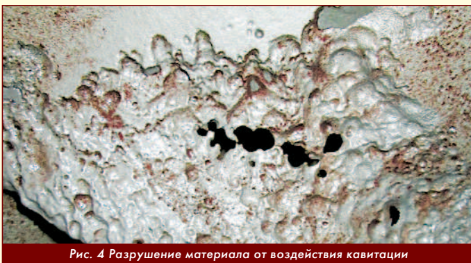
Рис. 4 Разрушение материала от воздействия кавитации
