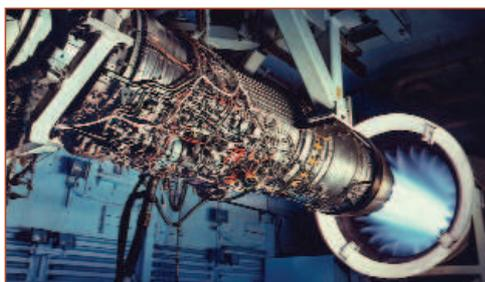
Рис. 1.127 Огневые испытания ТРДДФ F110-GE-400
