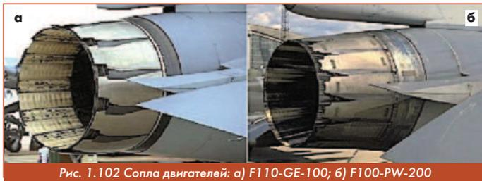
Рис. 1.102 Сопла двигателей: а) F110-GE-100; б) F100-PW-200
