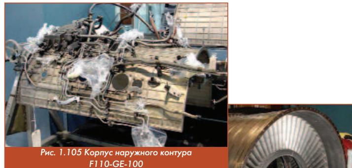
Рис. 1.105 Корпус наружного контура F110-GE-100
