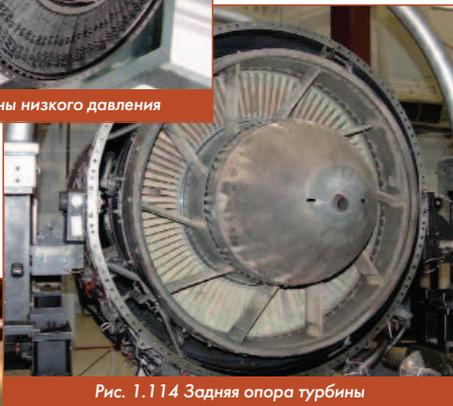
Рис. 1.114 Задняя опора турбины
