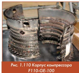
Рис. 1.110 Корпус компрессора F110-GE-100
