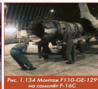
Рис. 1.134 Монтаж F110-GE-129 на самолёт F-16C
