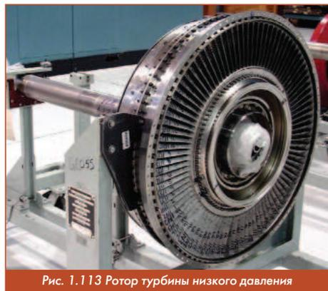
Рис. 1.113 Ротор турбины низкого давления
