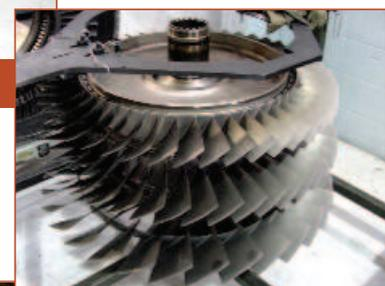
Рис. 1.108 Ротор вентилятора
