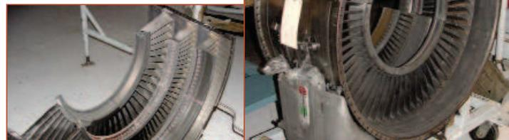
Рис. 1.106 Статор вентилятора
