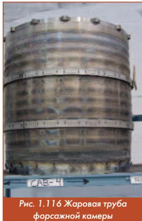
Рис. 1.116 Жаровая труба форсажной камеры
