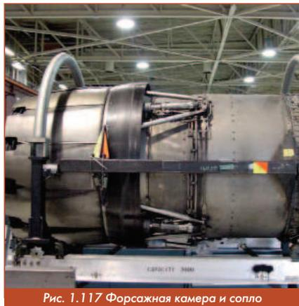
Рис. 1.117 Форсажная камера и сопло
