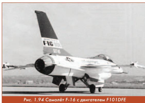
Рис. 1.94 Самолёт F-16 с двигателем F101DFE
