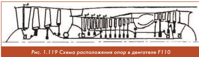
Рис. 1.119 Схема расположения опор в двигателе F110
