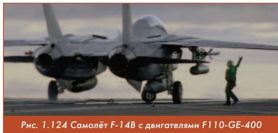
Рис. 1.124 Самолёт F-14B с двигателями F110-GE-400
