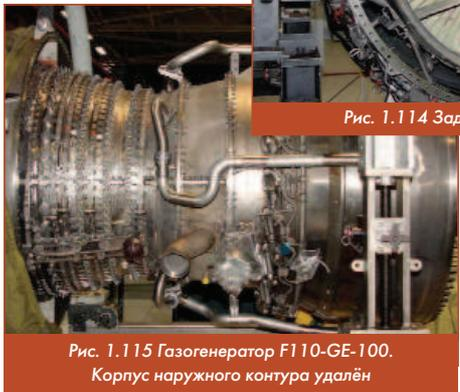
Рис. 1.115 Газогенератор F110-GE-100. Корпус наружного контура удалён
