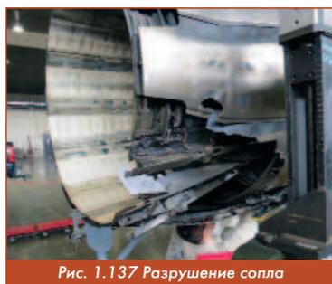
Рис. 1.137 Разрушение сопла
