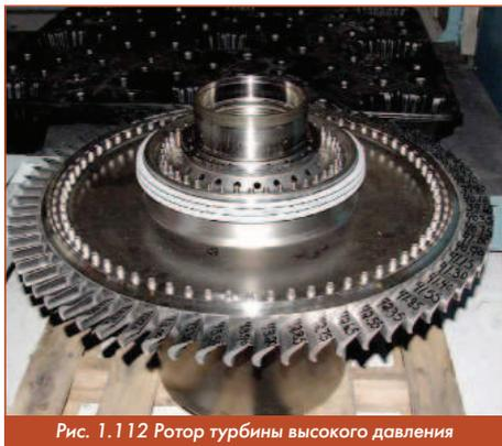
Рис. 1.112 Ротор турбины высокого давления
