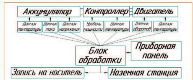
Рис. 4 Схема контроля параметров работы ЭВМГ
