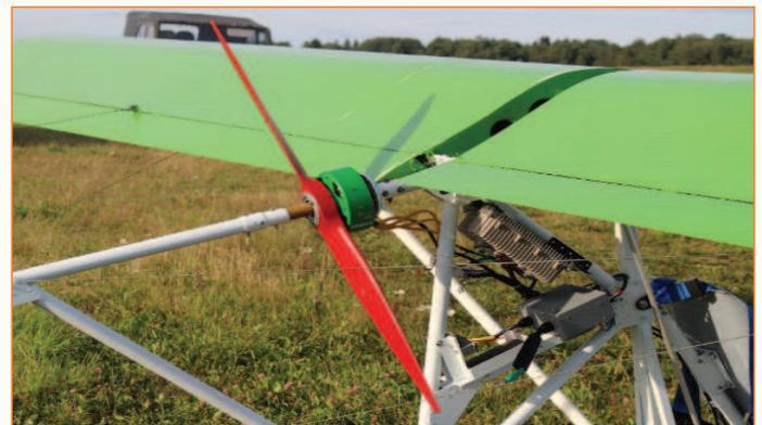
Рис. 3 Воздушный винт, разработанный и изготовленный группой исследователей, компоновка ЭВМГ на самолёте
