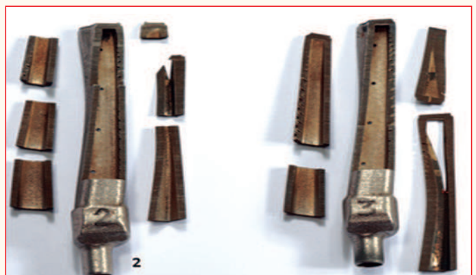
Рис. 9 Разрезанные образцы моделей каналов после проведенных испытаний
