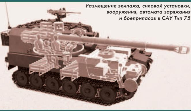
Орудие использовало боеприпасы раздельного заряжания с метательным зарядом в текстильных картузах. Снаряды массой 43 и 45 кг и картузы досыпаются автоматикой заряжания в камору без участия человека.
