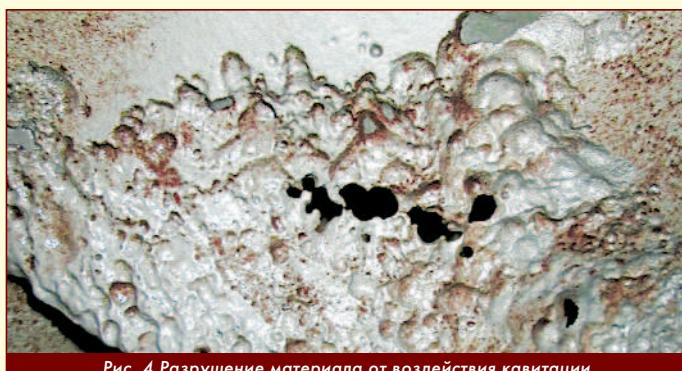
Рис. 4 Разрушение материала от воздействия кавитации
