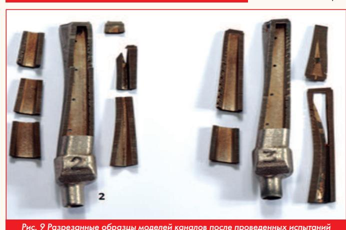
Рис. 9 Разрезанные образцы моделей каналов после проведенных испытаний
