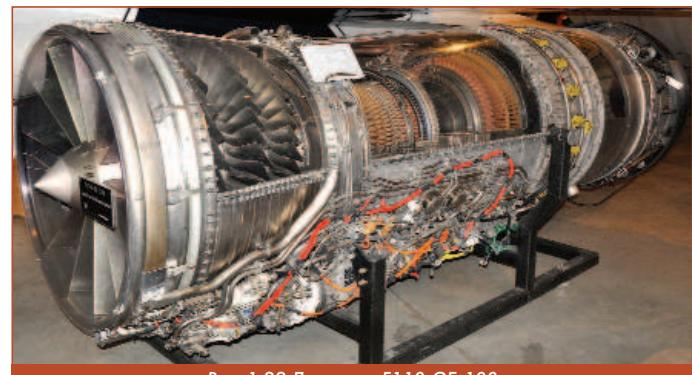
Рис. 1.99 Двигатель F110-GE-100
