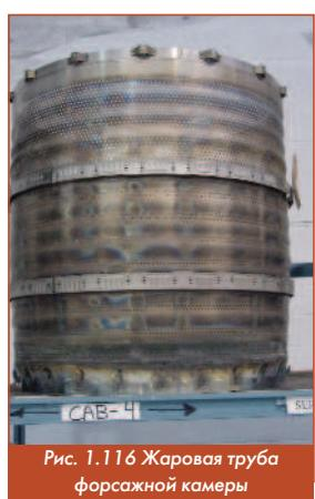
Рис. 1.116 Жаровая труба форсажной камеры
