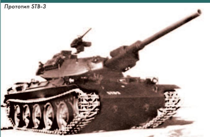
В 1971 году был построен прототип STB-3 с новой расширенной башней и увеличенными углами наклона брони.
