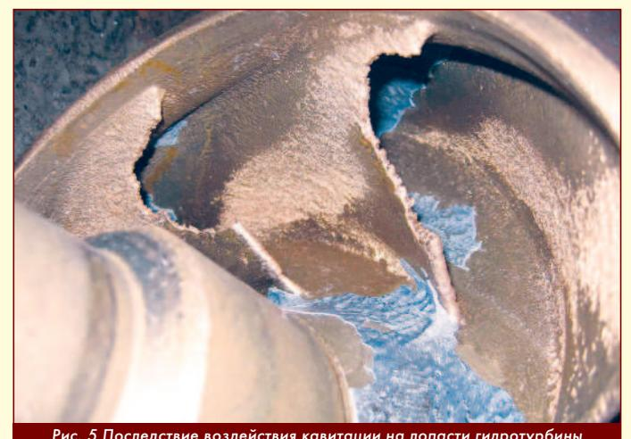
Рис. 5 Последствие воздействия кавитации на лопасти гидротурбины
