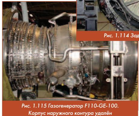
Рис. 1.115 Газогенератор F110-GE-100. Корпус наружного контура удалён
