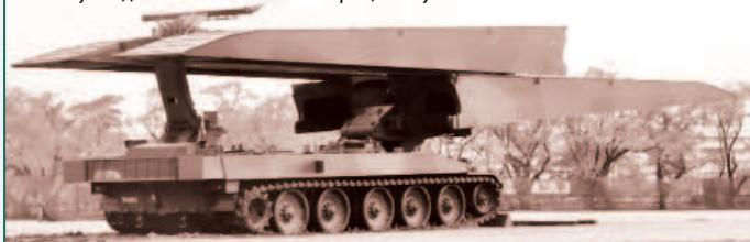
Мостоукладчик Тип 91 на заключительном этапе установки моста
