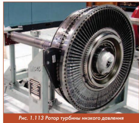
**Турбина низкого давления (вентилятора)** - неохлаждаемая двухступенчатая (рисунок 1.113).
