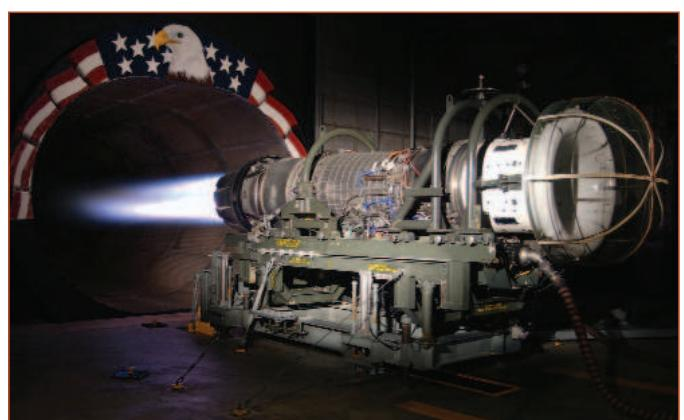
Рис. 1.121 ТРДДФ F110-GE-100 для F-16C на испытаниях в Южной Дакоте (South Dakota)
