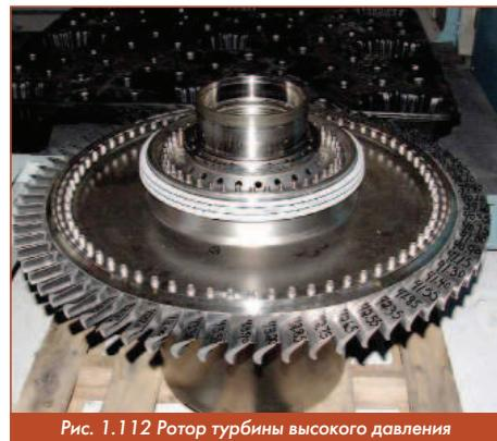
Рис. 1.112 Ротор турбины высокого давления
