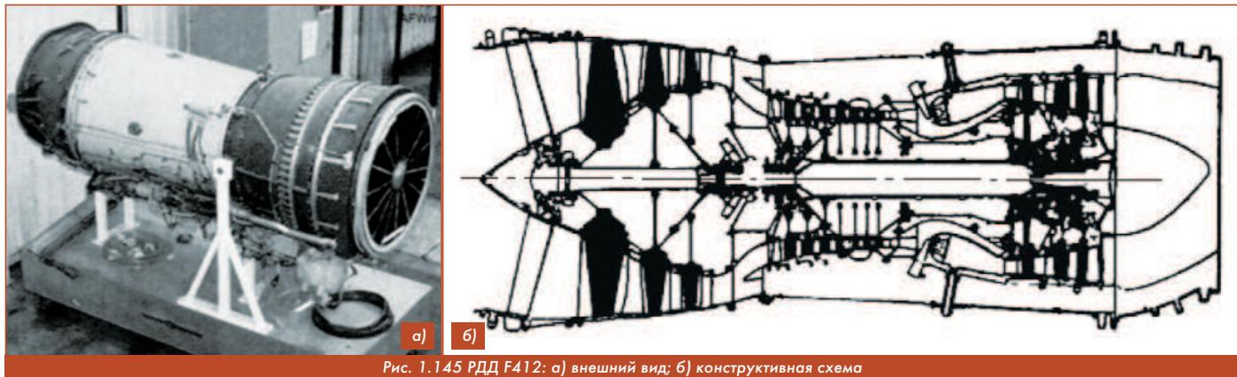
Рис. 1.145 РДД F412: а) внешний вид; б) конструктивная схема
