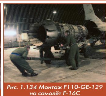
Рис. 1.134 Монтаж F110-GE-129 на самолёт F-16C
