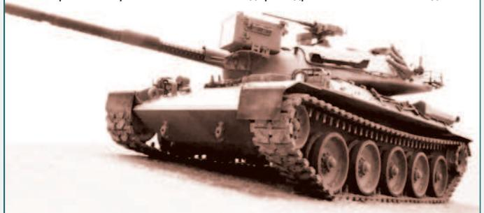
В ходовой части использовано по пять обрезиненных двухскатных опорных катков большого диаметра с каждого борта без поддерживающих катков. Натяжение гусениц регулируется с места механика-водителя с помощью гидропривода натяжного механизма.
