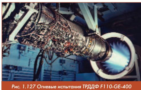
Рис. 1.127 Огневые испытания ТРДДФ F110-GE-400
