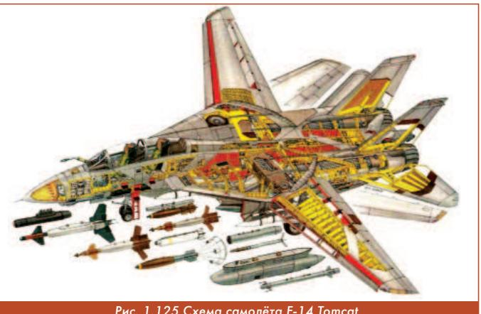
Рис. 1.125 Схема самолёта F-14 Tomcat
