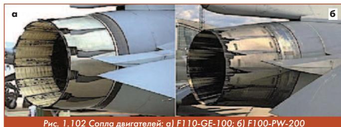
Самолёты F-16C/D Block 30/32 были первыми, построенными с отсеком двигателя, приспособленным для монтажа как двигателей F100-PW-200 (Block 32), так и General Electric F110 (Block 30) (рисунок 1.103).
