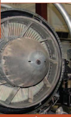
Рис. 1.114 Задняя опора турбины
