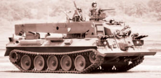
Надо отметить, что БРЭМ получила от танка Тип 74 гидропневматическую подвеску, которая применялась для уменьшения клиренса машины при выполнении буксировочных работ.
