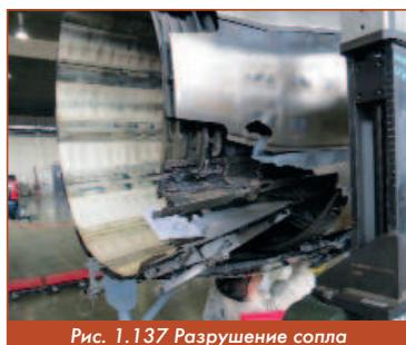
Рис. 1.137 Разрушение сопла
