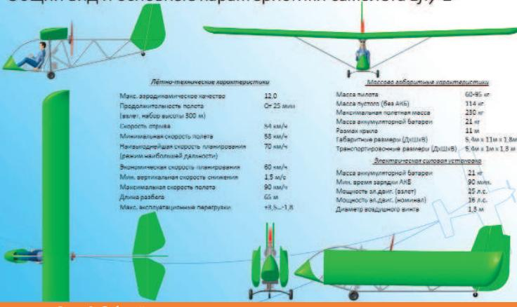
Рис. 1 Общий вид и основные характеристики электросамолета
