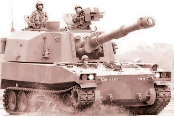
155-мм нарезная гаубица, разработанная компанией Japan Steel Works, получила ствол длиной 30 калибров, оснащенный развитым двухкамерным дульным тормозом и эжектором. Конструкция орудийной установки позволяла поднимать ствол на угол до 65°. Круговое вращение башни обеспечивало стрельбу в любом направлении. Наведение в штатном режиме осуществлялось гидравликой, которая получала команды от джойстика. На случай поломки автоматизированных систем самоходка имеет ручные приводы.
