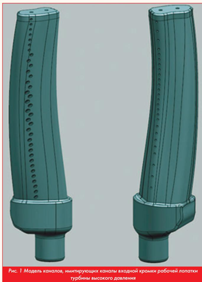
Рис. 1 Модель каналов, имитирующих каналы входной кромки рабочей лопатки турбины высокого давления
