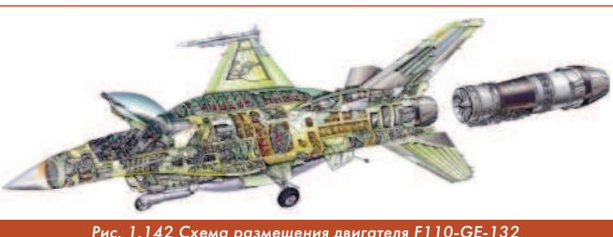
Рис. 1.142 Схема размещения двигателя F110-GE-132 на самолёте F16E/F Block 60
