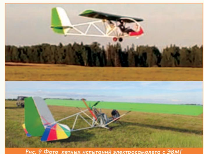
Рис. 9 Фото летних испытаний электросамолета с ЭВМГ
