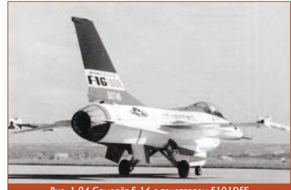
Рис. 1.94 Самолёт F-16 с двигателем F101DFE
