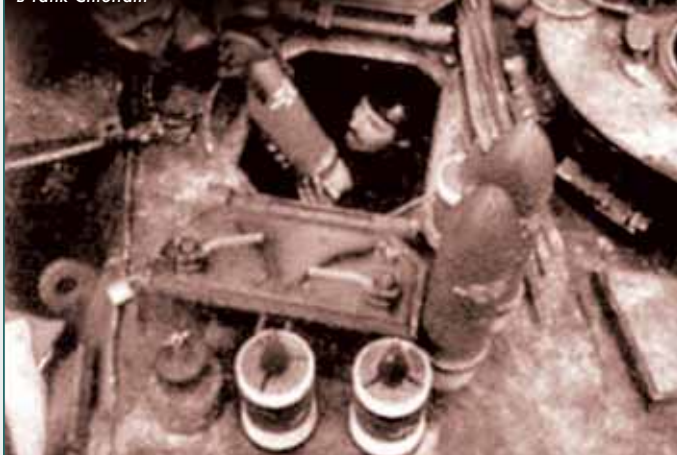
Загрузка осколочно-фугасных и бронебойно-подкалиберных снарядов в танк Chieftain
