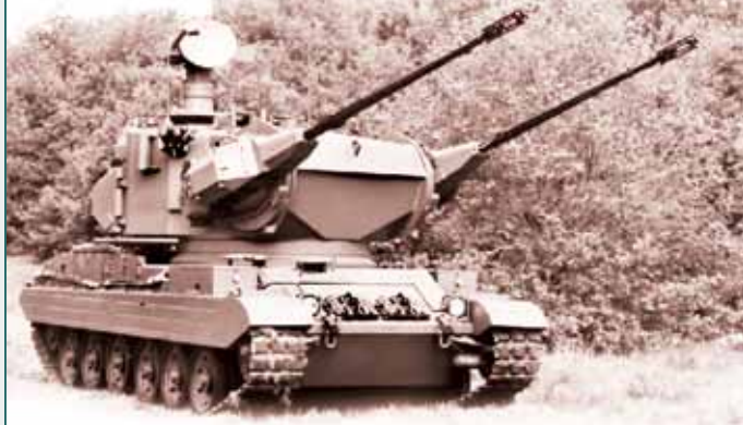
ЗСУ с башней фирмы Marksman на шасси танка Chieftain
