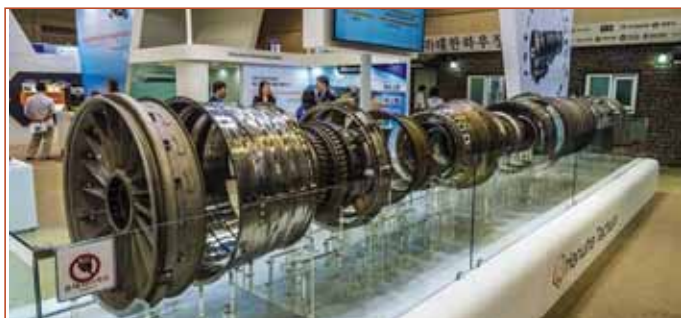
Рисунок 1.77 -Основные модули ТРДД F404-GE-102
