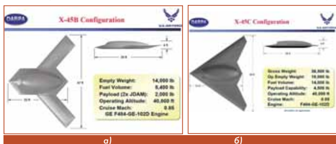
Рисунок 1.81 - Проекции и некоторые параметры БПЛА:а) X-45Ви б) X-45С
