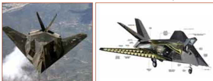
а) Рисунок 1.83 - Ударный самолёт Lockheed-F-117A-Nighthawk. б) структурная схема
