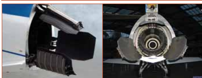
Рисунок 1.65 - Система отклонения вектора тяги двигателя на самолёте X-31A: а) - вид сбоку; б) - вид со стороны сопла ТРДД F404-GE-400
