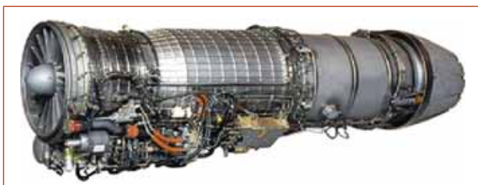
Рисунок 1.46 - Конструктивная схема ТРДДФ F404-GE-400
