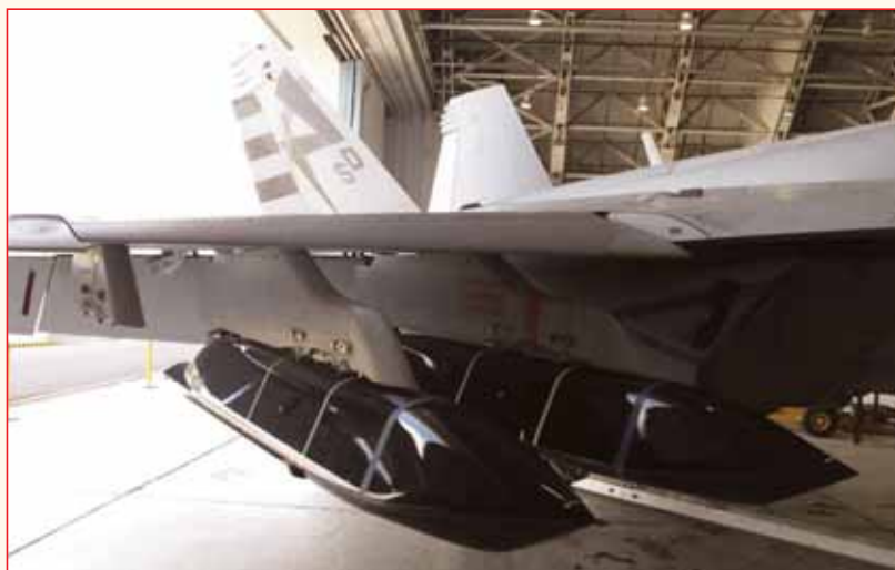
Рис. 2 Крылатые ракеты AGM-158C LRASM под крылом F/A-18
