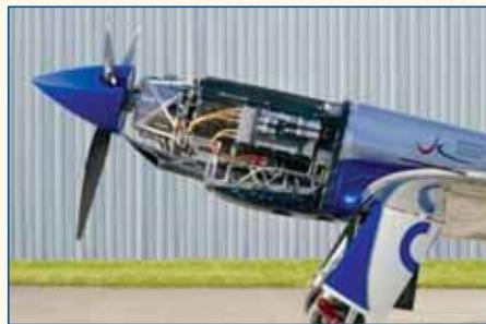
Несколько иной подход к созданию самолётов с электродвигателем у французских конструкторов из компании МАСА, которые решили отказаться от традиционной электрической схемы с аккумуляторными батареями в пользу системы с водородными топливными элементами. Такой подход объясняется основным предназначением проектируемого ЛА: участие в гонки на летающих автомобилях с электрической СУ подобно гонкам
