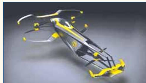
Летающий автомобиль длиной 5 метров имеет кабину для одного пилота. Шесть электродвигателей с пропеллерами, суммарной мощностью 35 кВт, будут способны поднять этот вертикально взлетающий ЛА массой 600 кг в воздух и разогнать его до 250 км/ч.
