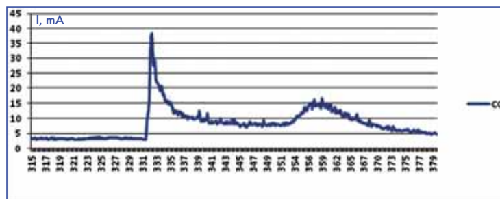
Рис.5. Показания датчика CO (токовый сигнал 4 mA на выходе датчика соответствует нулевой концентрации CO)
