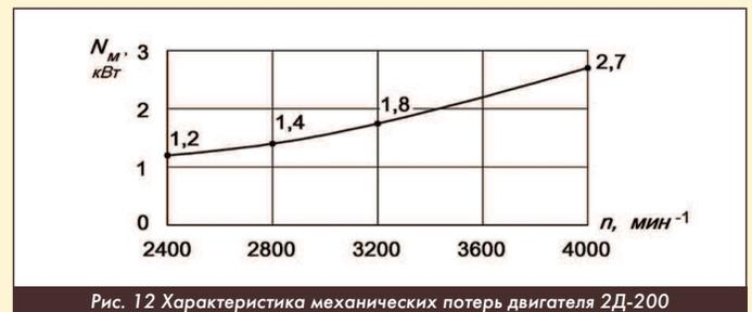
Рис. 12 Характеристика механических потерь двигателя 2Д-200
