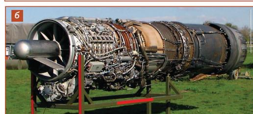
Рисунок 1.5 - Конструктивная схема а) и внешний вид б) ТРДФ J-79
