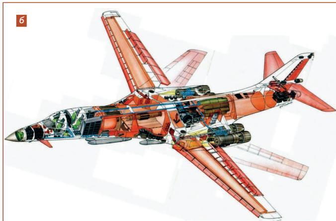
Рисунок 1.30 - Самолёт В-1А (а) и схема расположения двигателей F101 на нём (б)
