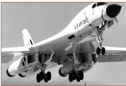
Рисунок 1.34 - Двигатели F101 в мотогондолах В-1А
