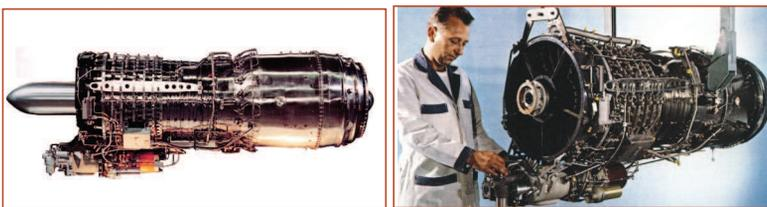
Рисунок 1.7 - Газогенератор-демонстратор GE1; а) - внешний вид, б) - сборка
