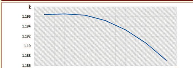
Рис. 3 Расчетная зависимость показателя адиабаты от степени расширения
