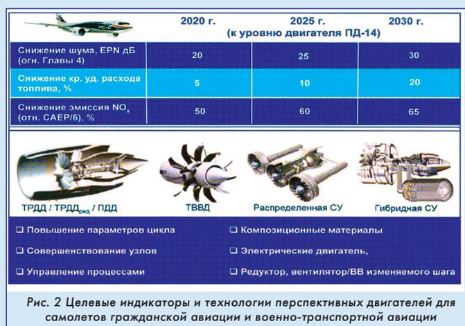
пени двухконтурности с редуктором, двигатель с “открытым ротором”, с регенерацией тепла, с промежуточным охлаждением, “интеллектуальные” двигатели с применением нано- и MEMS-технологий, “электрические” двигатели со встроенным стартером-генератором, магнитными опорами вращающихся валов и другие ключевые критические технологии для обеспечения создания этих двигателей и их разработка представлены в работе [10].
