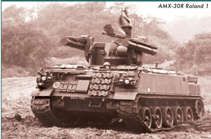
Пока шло его производство, он был модернизирован в целях обеспечения возможности применения в любых погодных условиях днём и ночью. Для этого была усовершенствована и ракета, и пусковая установка, на которую дополнительно установили радиолокационную антенну системы управления ракетой и соответствующее оборудование. В итоге в войска сначала поступал зенитно-ракетный комплекс AMX-30R Roland 1, которых успели изготовить 83 штуки, а с 1981 года перешли на изготовление AMX-30R Roland 2 (98 штук).
