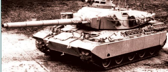
Но на следующей машине установили гладкоствольную 120-мм пушку GIAT CN120 G1, к которой в боекомплекте было два вида выстрелов: БОПС OFL 120 G1 и кумулятивный OECC 120.
