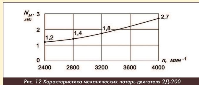
Рис. 12 Характеристика механических потерь двигателя 2Д-200
