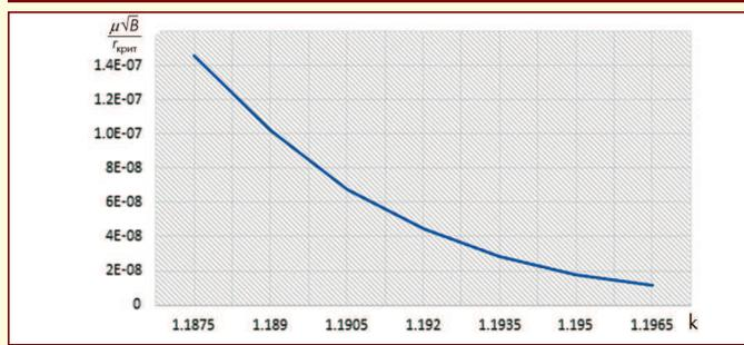
Рис. 6 Расчетная зависимость вязкоупругого критерия от показателя адиабаты
