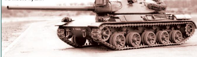
На последних предсерийных машинах на орудие был установлен кожух, а катки и забашенная корзина приобрели окончательную форму. Компоновка танка традиционная. Место механика-водителя в отделении
