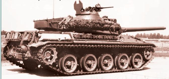
управления смещено в левую сторону, справа от него находилась часть боекомплекта (28 выстрелов). Здесь же находилась часть топливных баков. Вторая часть топливных баков размещалась в моторно-трансмиссионном отделении, их общая ёмкость составляла 960 л, что обеспечивало при движении по шоссе преодоление 520 км.
