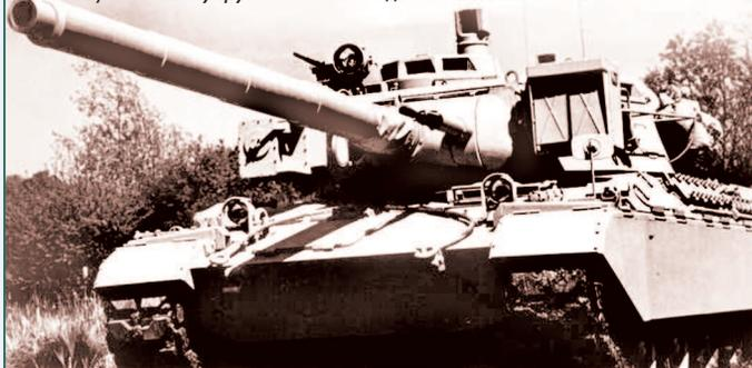
Однако мощности двигателя было недостаточно и двигатель заменили на Hispano-Suiza HS-110-2 SR мощностью 800 л.с. с коробкой передач SESM Minerva ENC 200 (как на AMX-30B2). Этот двигатель обеспечивал скорость до 65 км/ч по шоссе, а запаса топлива хватало на 530 км. Пушка осталась прежней. Только маска пушки вместо полукруглой стала прямоугольной.
