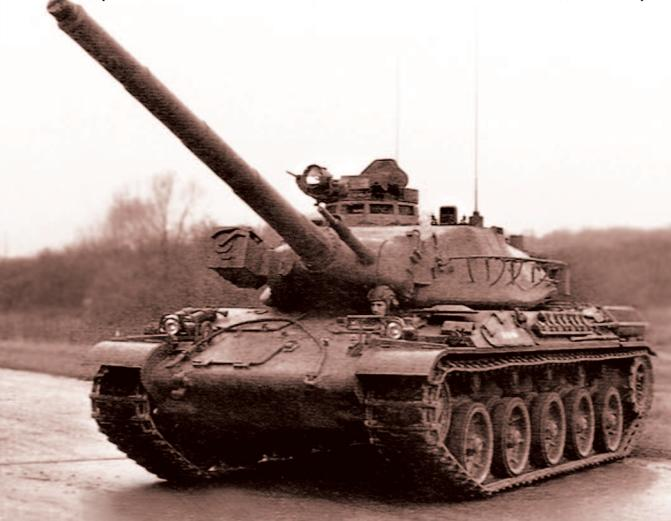
Ещё одним направлением повышение огневой мощи стало введение в боекомплект оперённого бронебойного подкалиберного снаряда OFL-105-F1, изготовленного из вольфрама. Так как пушка оптимизирована под применение кумулятивного снаряда, то недостаток стабилизации от вращения ОБПС компенсировался более длинным стволом пушки, что обеспечивало начальную скорость снаряда порядка 1525 м/с (выше, чем у английской L7 и американской M68).
