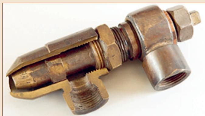
**Рис. 1 Паронефтяная форсунка Шухова**
