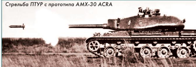
К концу 1974 года в ходе испытаний все проблемы были решены, противотанковый комплекс АМХ-30 АСРА подтвердил соответствие ТТТ и ПТРК АСРА с запускаемой через ствол орудия ПТУР был полностью готов к серийному производству. При принятии этого комплекса на вооружение он стал бы первым в мире танковым ПТРК с применением лазерного луча для целеуказания. Однако этого не произошло. За то время, пока комплекс АСРА доводился до уровня тактико-технических требований, появились системы
