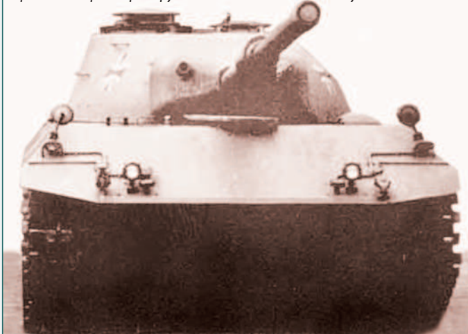
Прототип второй серии группы "Рейншталь" со 105-мм пушкой L7
