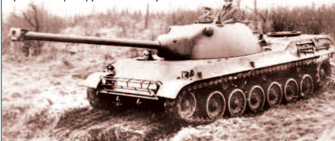
Прототип второй группы с 90-мм пушкой
