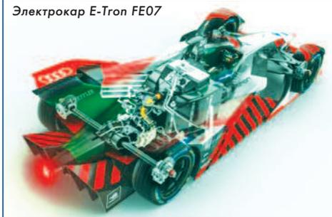
тов в минуту, и в нормальном режиме выдаёт 335 л.с. и в кратковременном - 382 л.с. Этого достаточно для разгона электрокара FE07 массой 900 кг до 100 км/ч всего за 2,8 секунды и обеспечивает ему максимальную скорость в 240 км/ч.
