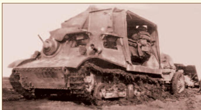
Т-20 "Комсомолец" преодолевал ров шириной 1,4 м, брод глубиной 0,6 м, стенку высотой 0,47 м и валил 18-см деревья. Впечатляет возможность движения при крене 40° (ограничивалось спаданием гусениц из-за коротких гребней траков) и подъёма по твердому грунту на 45-градусный склон. При полной боевой массе и с прицепом массой 2,0 т угол уменьшался до 18°. Радиус поворота без прицепа составлял всего 2,4 м.
