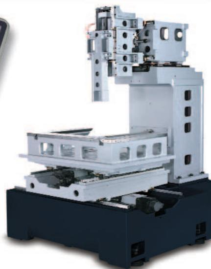
Цельнолитые несущие элементы конструкции из чугуна-механита с малым тепловым расширением. Оптимальное расположение ребер жесткости, рассчитанное методами анализа конечных элементов (FEM). Превосходные демпфирующие характеристики и высочайшая жесткость.
