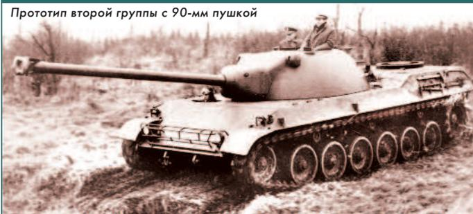
гусеницы. Верхняя ветвь гусеницы поддерживалась тремя катками. В трансмиссию от фирмы Pulsgetriebe входила восьмискоростная планетарная коробка передач PP45. Трудности были и при доведении двухтактного дизельного многотопливного двигателя жидкостного охлаждения Napomag мощностью 850 л.с. Силовая установка не была выполнена в виде моноблока как в прототипе от первой группы. Двигатель, трансмиссия и система охлаждения монтировались и демонтировались раздельно.
