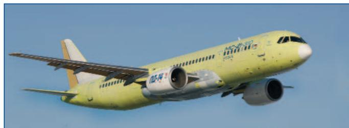
2018 г. на двигатель был выдан Сертификат типа Росавиации. Тяга двигателя на взлетном режиме - 14 тс, сухая масса - 2870 кг, диаметр вентилятора - 1900 мм. Благодаря применению инновационных технологий и материалов удельный расход топлива на 10...15 % ниже, чем у двигателей предыдущего поколения. ПД-14 соответствует современным требованиям по сертификации АП-33, FAR-33, CS-E, ETOPS. **П**
