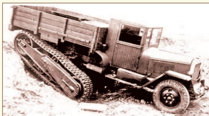
ЗИС-52 при нагрузке в 2,5 т по дорогам мог двигаться со скоростью 42 км/ч, по бездорожью и снежной целине (в зависимости от их характера) - от 8 до 20 км/ч. Вездеход мог преодолевать подъемы до 30°, броды глубиной до 0,6 м. Общая масса автомо-
