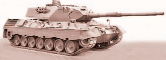
дополнительная броневая плита приваривалась. В результате удалось получить разнесённое бронирование, примерно эквивалентное применённому в башнях танков модификаций A3 и A4. Дополнительное бронирование увеличило массу танка примерно на 800 кг и довело до 42,4 т. Этой модернизации подлежали все ранее выпущенные танки "Леопард-1A1" в количестве 1845 машин. Новые модернизированные танки получили название "Леопард-1A1A1".
