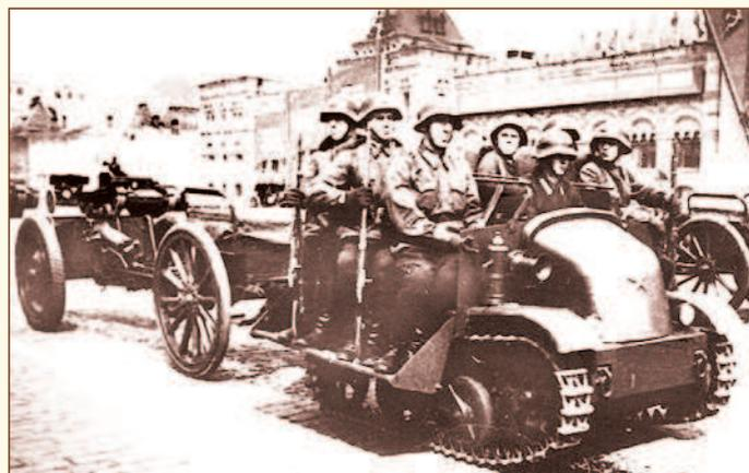
Их производство продолжалось в 1937 году, но после эксплуатации в войсках стало ясно, что без броневой защиты водителя, двигателя, радиатора и бензобака применять их на поле боя нельзя. К тому же "Пионер" был неустойчив при езде по неровностям и на поворотах, имел низкие тяговые свойства и малую вместимость. В 1937 году производство тягача-транспортёра "Пионер" было прекращено.
