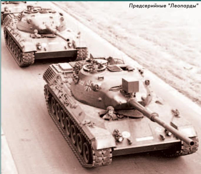
Войсковые испытания предсерийных машин закончились в сентябре 1965 года. И в сентябре того же года первый серийный Leopard сошёл с конвейера завода Kraus Maffei AG. Он отличался от предсерийных машин установкой круглого люка у заряжающего и смещением влево прожектора для обеспечения командиру танка большей видимости.
