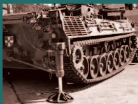
максимальная грузоподъемность кранового оборудования БРЭМ была повышена до 25 т. Полная масса БРЭМ, получившая название *Bergepanzer 2A2* возросла до 40,6 т. Бундесвером было заказано и закуплено 100 таких БРЭМ еще восемь БРЭМ *Bergepanzer 2A2* были заказаны Канадой.
