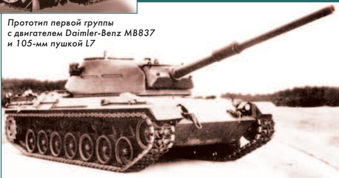
Изготовление прототипа группы "Рейншталь" испытывало затруднения из-за сложности при доведении индивидуальной гидропневматической подвески и механизма поворота с гидрообъёмной передачей. Гидропневматическая подвеска включала шесть опорных катков, ведущего колеса сзади и направляющего в носовой части с гидравлическим механизмом натяжения.
