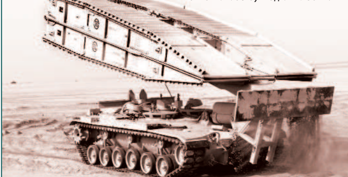
Танковый мостокладчик M60 AVLБ
