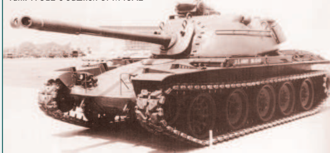
Танк T95E2 с башней от M48A2
