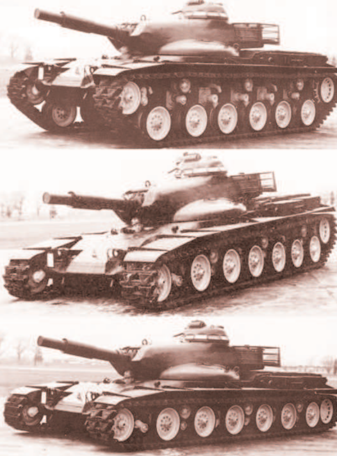
Т96 со 152-мм ПУ и переменным клиренсом
