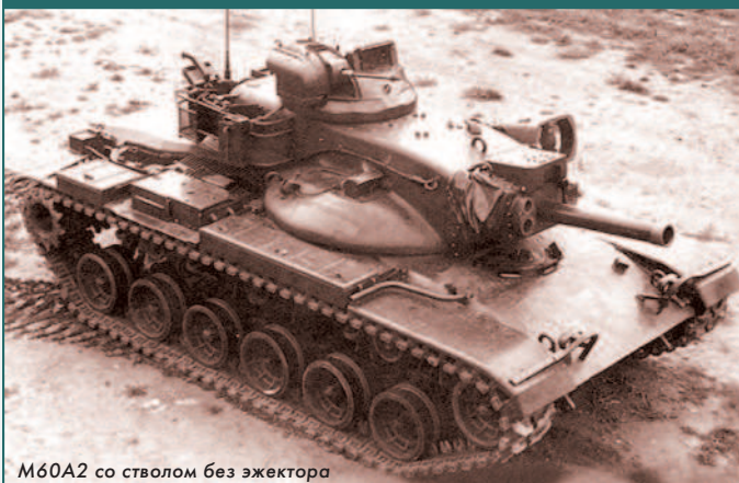
М60А2 со стволом без эжектора
