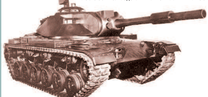
М60 с башней модели "К" и 152-мм ПУ ХМ150
