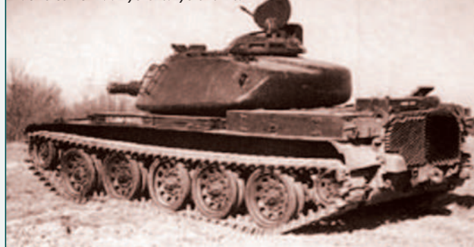
T95E8 со 152-мм пусковой установкой
