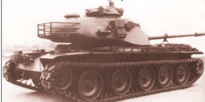
T95E1 с башней в положении "по-походному"
