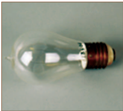
Рис. 4 Лампа накаливания с угольной нитью Германия. К. XIX - н. XX вв. Сименс и Гальске (Siemens & Halske) ПМ. Коллекция "Источники света"
