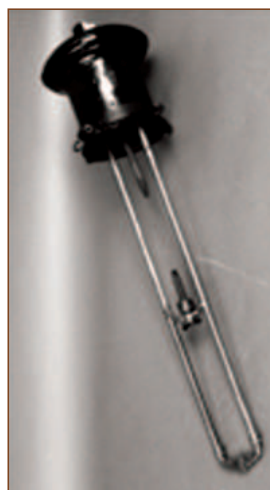
Рис. 2 Лампа дуговая с автоматическим регулятором. Россия. К. XIX - н. XX вв. П.М. Коллекция "Источники света"
