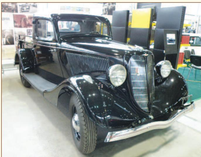
В качестве силового агрегата пикап ГАЗ-М-415 получил точно такой же двигатель, которым комплектовали «Эмки», хотя изначально планировалось его заменить шестицилиндровым двигателем ГАЗ-11 (3,5 литра, 76 л.с.). Но освоить производство нового двигателя сразу не получилось. ГАЗ-М-415 комплектовался двигателем объёмом 3285 см<sup>3</sup> и мощностью 50 л.с., которой было достаточно для разгона до 90 км/ч.
