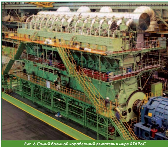
Рис. 6 Самый большой корабельный двигатель в мире RTA96C
