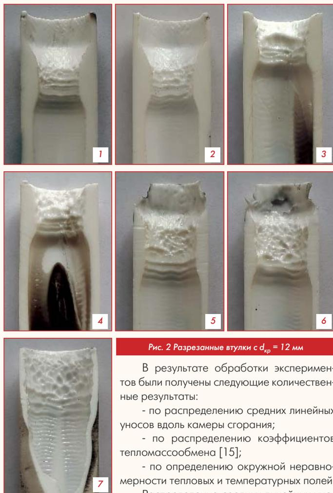
Рис. 2 Разрезанные втулки с  $d_{кр} = 12$  мм
