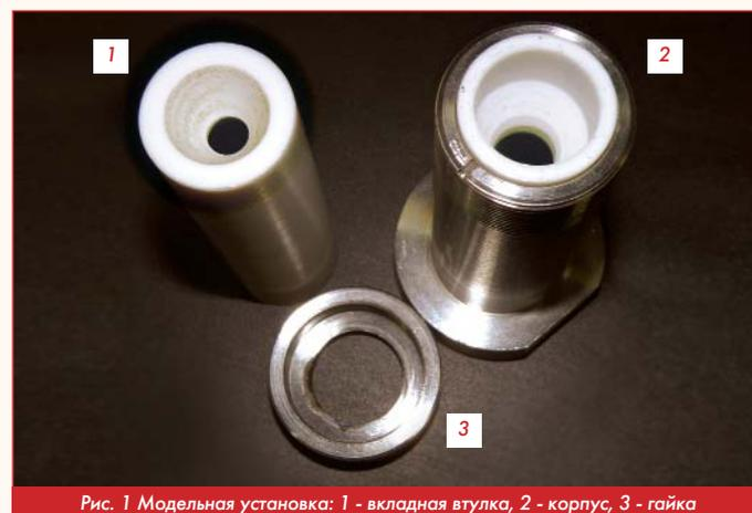
Рис. 1 Модельная установка: 1 - вкладная втулка, 2 - корпус, 3 - гайка
