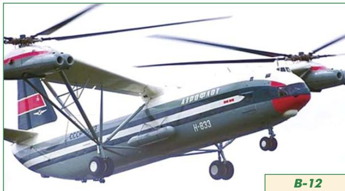
Уяснив положительные и отрицательные стороны аппаратов продольной схемы, Миль в 1962 г. пришел к выводу о необходимости изменения компоновки вертолета и переходу к поперечной схеме. Определенную роль в этом сыграл и опыт создания винтокрыла Ка-22.
