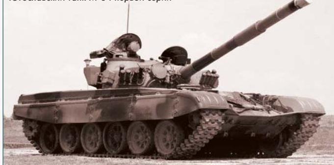
Корпус М-84 был сварной, состоял из листов и штампованных деталей. Толщина бронелистов и конструкция комбинированных преград не менялась. Лобовая проекция бронекорпуса и башни прикрывалась блоками системы динамической защиты "Контакт".
