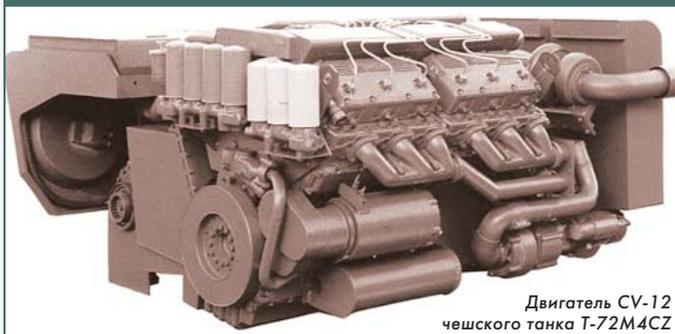
Двигатель CV-12 чешского танка T-72M4CZ
