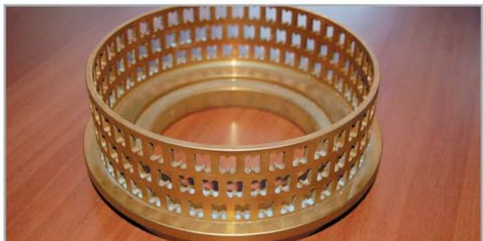
Технологическая проработка показала, что при обработке таких деталей выгодно использовать ЭЭ проволочно-вырезной станок, оснащенный автоматическим программно-управляемым поворотным столом. При этом производительность может повыситься почти в 1,3 раза, а точность – практически на порядок.
