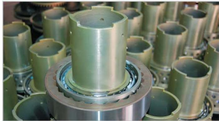
В настоящее время паз обрабатывается мелкой фрезой диаметром менее 4 мм на станке с ЧПУ. Операция малопроизводительна и трудоемка даже при использовании современного обрабатывающего центра, так как стойкость фрезы невелика.
