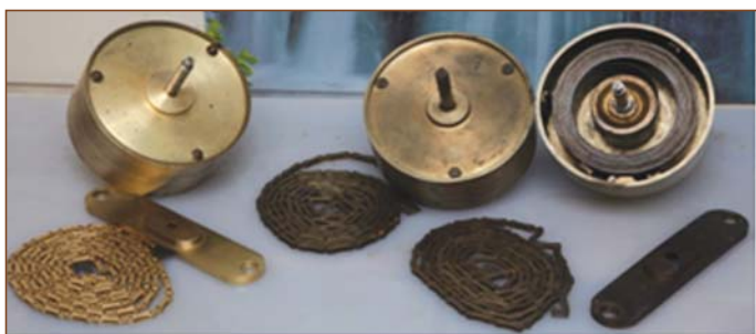
Рис. 6. Пружины и цепи двигателя часов Карася
