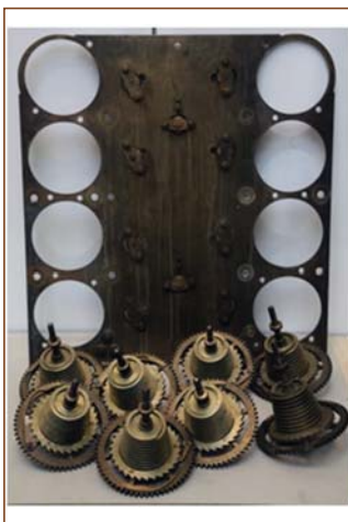
Рис. 5. Фузеи и монтажная панель двигателя часов Карася
