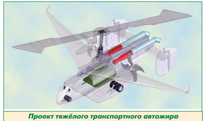
В этой конструкции скombинированы принципы экраноплана и автожира (динамическая воздушная подушка, возникающая на поверхностях корпуса катамарана и крыльях экраноплана + несущая способность ротора) т.е. своего рода экранолет, в котором роль верхнего "самолетного бипланного" крыла играет ротор автожира.
