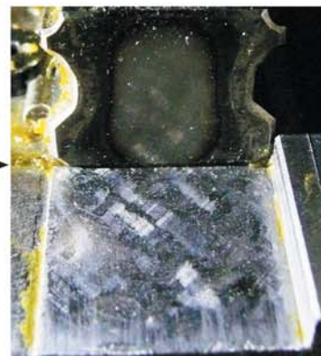
Явно шлифованная поверхность с установленной линейной направляющей японского станка «не-Содик». Станок потерял точность всего за 4 года (фото сделано по время ремонта)
