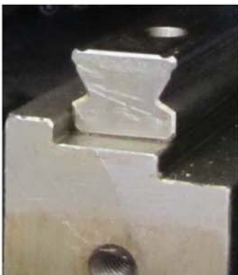
Явно шлифованная поверхность с установленной линейной направляющей японского станка «не-Содик». Станок потерял точность всего за 4 года (фото сделано по время ремонта)
