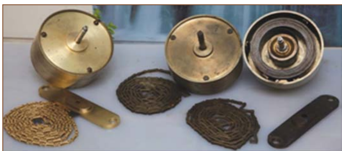
Рис. 6. Пружины и цепи двигателя часов Карася
