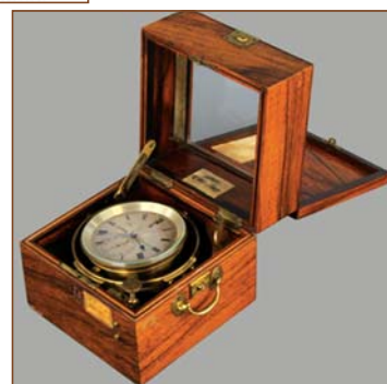
Рис. 10. Хронометр морской настольный механический с термометром Реомюра. Россия. С.Петербург. Часовой мастер Бернгардт Пиль. 1870-е гг.
