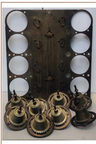
Рис. 5. Фузеи и монтажная панель двигателя часов Карася
