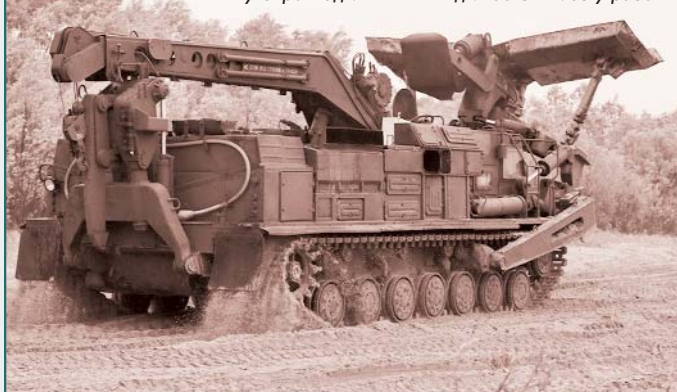
Путепрокладчик БАТ-2 выдвигается к месту работы
