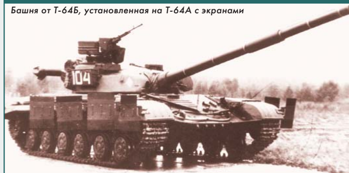
Башня от Т-64Б, установленная на Т-64А с экранами
