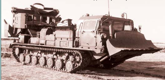
Котлованная машина МДК-3 в транспортном положении
