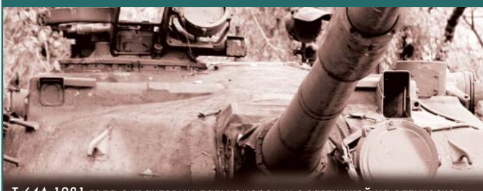
Т-64А 1981 года с квантовым дальномером и с заглушкой на оптическом
