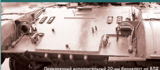
Приваренный дополнительный 30-мм бронелист на ВЛД
