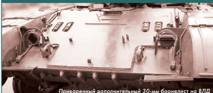
Приваренный дополнительный 30-мм бронелист на ВЛД
