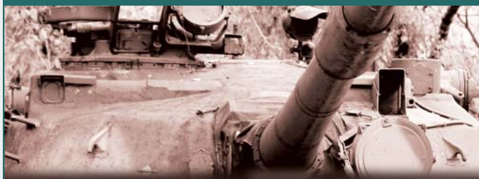
Т-64А 1981 года с квантовым дальномером и с заглушкой на оптическом
