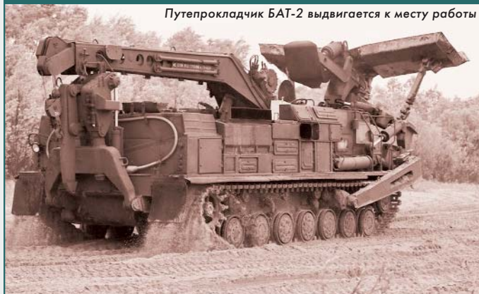
Путепрокладчик БАТ-2 выдвигается к месту работы
