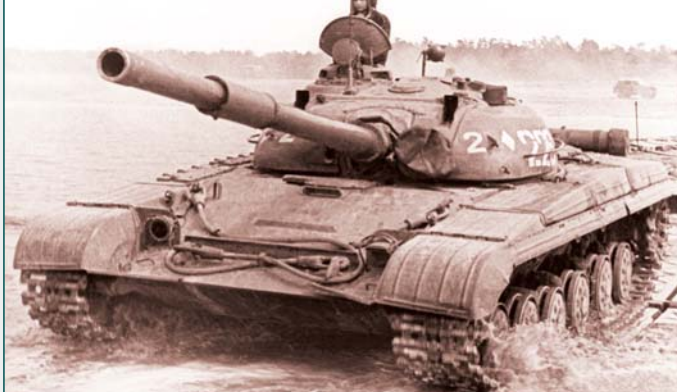
Серийный танк Т-64 с прямой ВЛД
