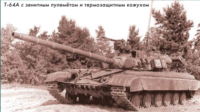
Т-64А с зенитным пулемётом и термозащитным кожухом
