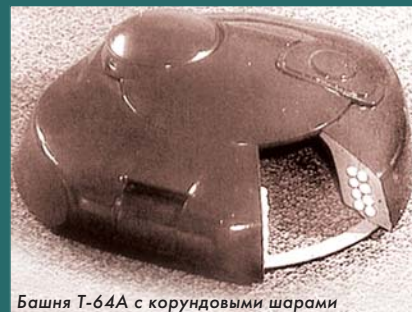
Башня Т-64А с корундовыми шарами
