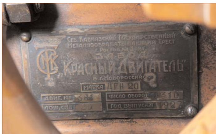
Рис. 2 Шильдик с техническими характеристиками двигателя
