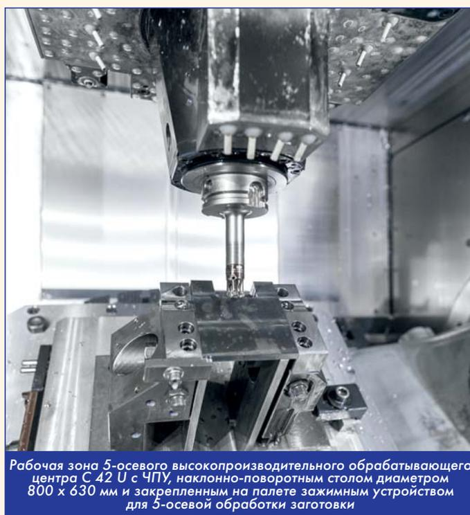
Рабочая зона 5-осевого высокопроизводительного обрабатывающего центра С 42 U с ЧПУ, наклонно-поворотным столом диаметром 800 x 630 мм и закрепленным на палете зажимным устройством для 5-осевой обработки заготовки
