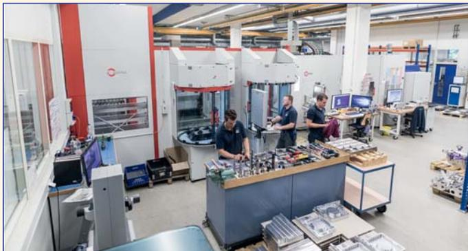
Универсальный технологический участок с тремя полностью интегрированными 5-осевыми высокопроизводительными обрабатывающими центрами С 42 U с ЧПУ, роботизированной системой RS2-L и двойным магазином для хранения и загрузки заготовок и инструментов (обе станции оснастки находятся посередине)
