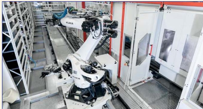
Вид сверху на универсальный технологический участок с магазином для палет заготовок слева и сзади, магазином на 200 инструментов справа, подсоединением для обрабатывающего центра С 42 U справа спереди и многофункциональным роботом посередине в качестве манипулятора для палет заготовок и инструментов
