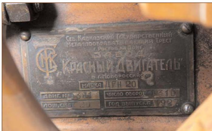
**Рис. 2 Шильдик с техническими характеристиками двигателя**
