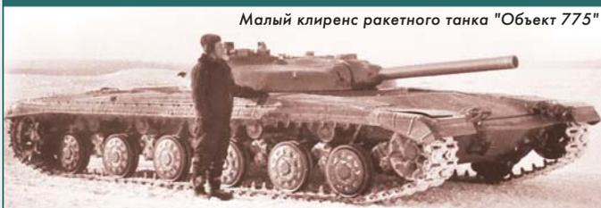
Дизельная силовая установка и трансмиссия "Объекта 775" были заимствованы у танка Т-64 и подверглись небольшим изменениям. На испытаниях "Объекта 775" подтвердились его хорошие подвижность и проходимость, незаметность и меньшая степень уязвимости благодаря низкому силуэту и изменяемому клиренсу, но на вооружение ракетный танк "Объект 775" не был принят из-за сложности ПТРК "Рубин" и низкой надежности системы наведения управляемых ракет.
