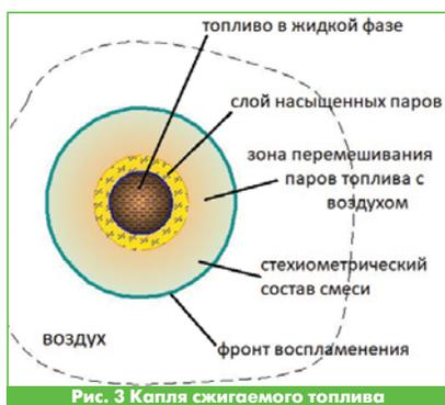
Рис. 3 Капля сжигаемого топлива
