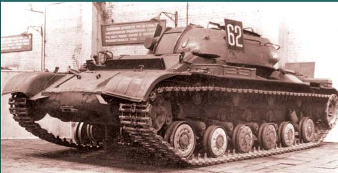
Опытный образец шасси танка "Объект 430"
