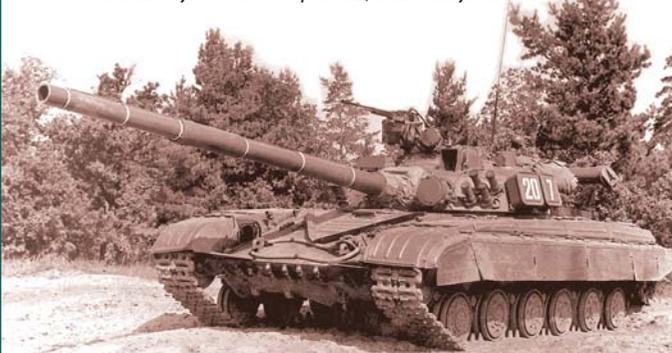
Кроме линейных танков Т-64А выпускался командирский вариант - танк Т-64АК ("Объект 446"). От линейных танков он отличался наличием коротковолновой радиостанции Р-130М с комбинированным антенным устройством, навигационной аппаратуры, перископической артиллерийской буссоли и бензоэлектрического зарядного агрегата.
