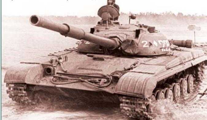
Башня из литой брони средней твердости, лобовая часть и борта в секторе 35° имели комбинированные вставки в виде полости, заполненной алюминиевым сплавом. Суммарная толщина брони была от 570 мм (в лобовой части) до 600 мм (в нижней части) башни. Тем самым обеспечивалась защита лобовой проекции танка при обстреле зарубежными 105-мм кумулятивными и бронебойно-подкалиберными снарядами с сердечником из карбида вольфрама или вольфрамового сплава при обстреле с дальности свыше 500 м.
