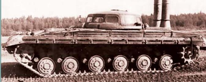
В ходе испытаний стало понятно, что у спаренной системы газотурбинных двигателей перспектив нет: силовая установка с двумя двигателями и оригинальным редуктором получилась сложнее в производстве и эксплуатации, а также дороже, чем один ГТД эквивалентной мощности с обычной трансмиссией. Предпринимались некоторые попытки развить двухдвигательную схему, но в итоге конструкторы ЛКЗ и Завода им. Климова остановили работы в этом направлении.
