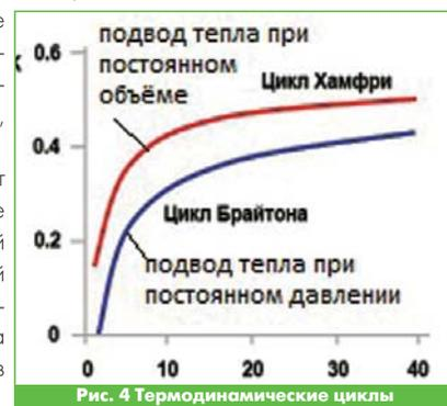
Рис. 4 Термодинамические циклы
