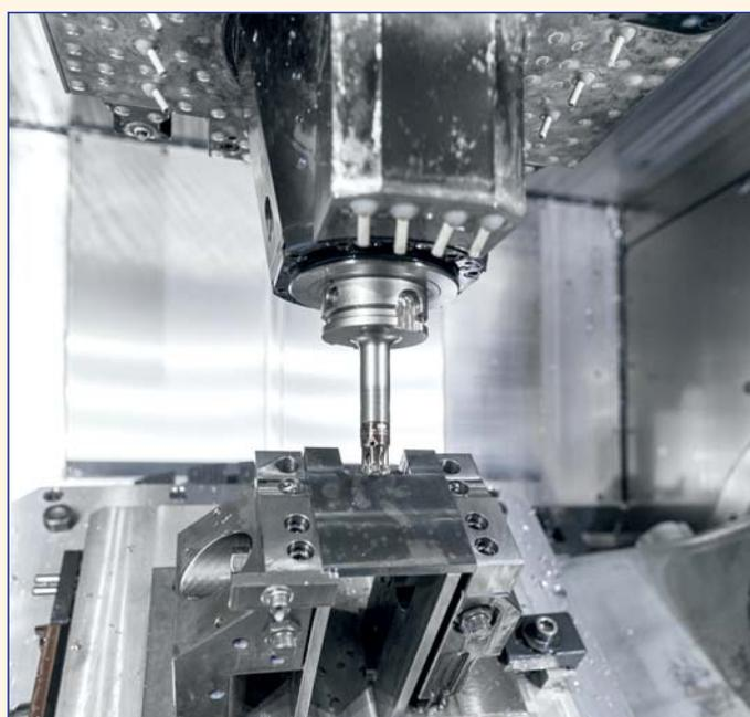
Рабочая зона 5-осевого высокопроизводительного обрабатывающего центра С 42 U с ЧПУ, наклонно-поворотным столом диаметром 800 x 630 мм и закрепленным на палете зажимным устройством для 5-осевой обработки заготовки
