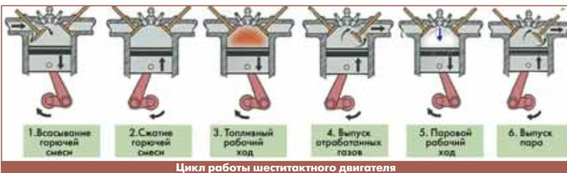
Цикл работы шеститактного двигателя
