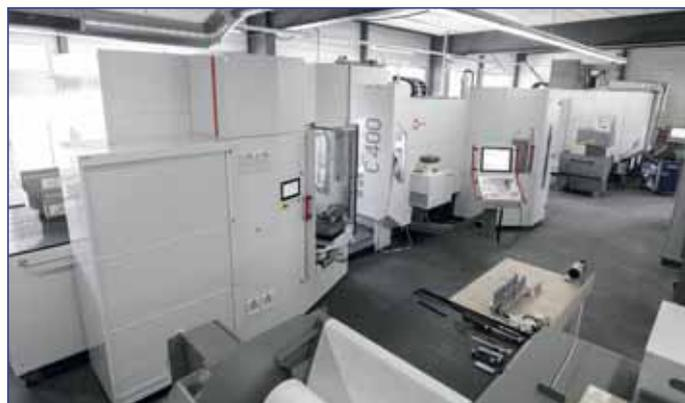
"Бульвар Hermle" на фирме Feusi AG с 5-осевым обрабатывающим центром C 400 U, оснащенный магазином заготовок, 5-осевым обрабатывающим центром C 22 U с устройством смены палет PW 150 и 5-осевым обрабатывающим центром C 42 U/MT с функцией вращения
