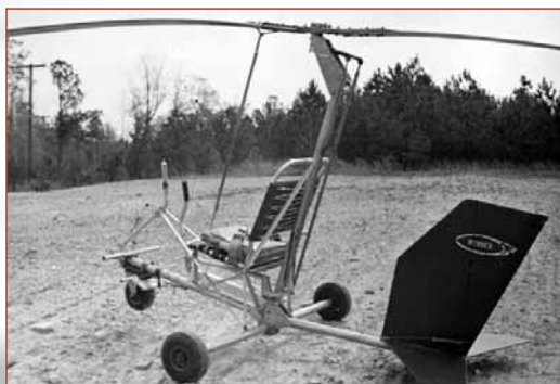
Безмоторный вариант буксируемого планера - автожира Bensen Model B-7 Gyro-Glider
